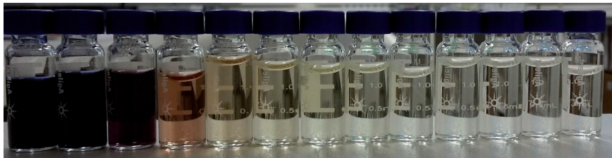
Vyčistenie vysoko koncentrovanej znečistenej odpadovej vody z textilného priemyslu elektrochemickou oxidáciou do environmentálne prijateľného stavu.
